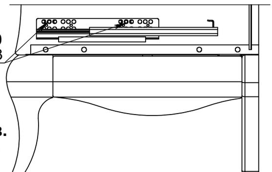
**ВНИМАНИЕ:** дополнительные отв. даны для регулировки ящиков по глубине
