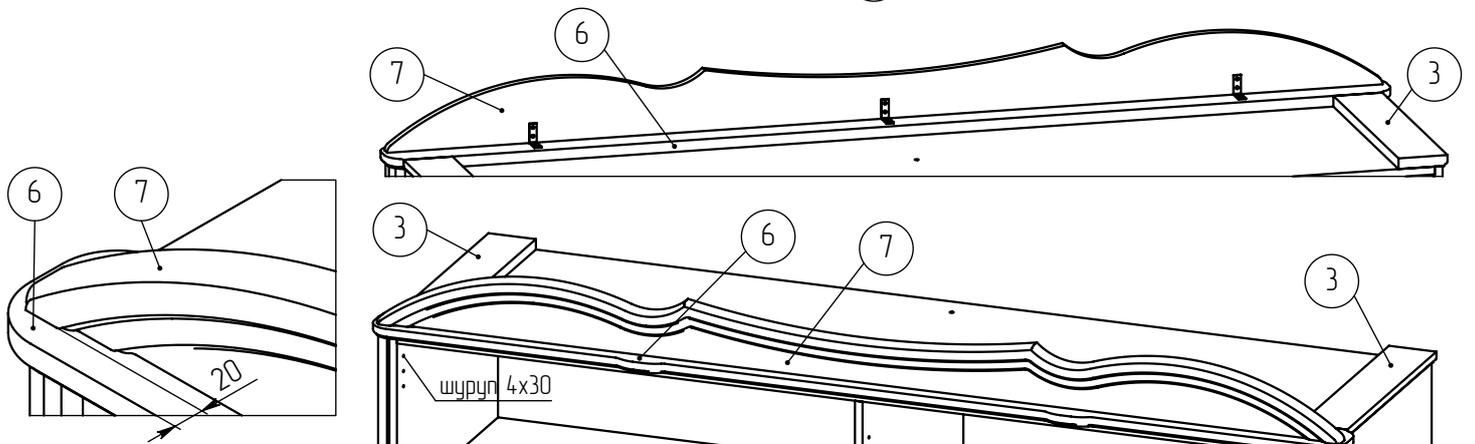
Монтаж карнизов (3), (6), накладок (5) произвести шурупами 4x30 через соответствующие отверстия в боковых и верхних стенках шкафа.
