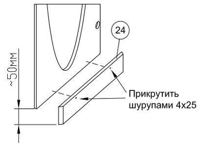
регулировка положения накладки метабокса
