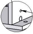
Сквозное отверстие использовать с обратной стороны для затяжки эксцентрика.
