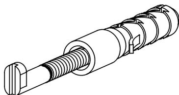
Просверлить отверстие в стене и забить дюбель. Закрутить в него крючок и повесить на него подвески центральные установленные в полке.
