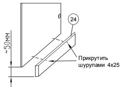
регулировка положения накладки метабокса
