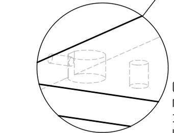
Сборка с помощью стяжки эксцентриковой и дюбеля винчиваемого
