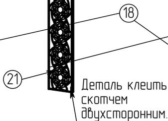
Схема установки стабилизаторов.
