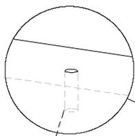
Дополнительный крепеж детали поз. 9 шурупы 4x25
