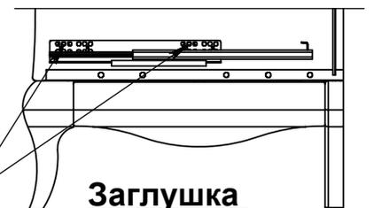
**Эксцентрик**    **Стабилизатор**    **Заглушка эксцентрика**
