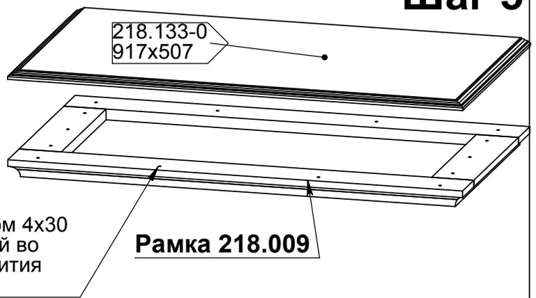
Крышку 218.133 к рамке 218.006 крепить шурупом 4x30 только отвёрткой во избежание разбития отверстия
